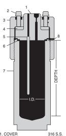
1. COVER 2. SET SCREW 3. CAP 4. THRUST RING 5. GASKET
