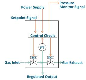
Fig. 1 EPR Diagram
